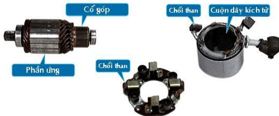
Hình 5.5: Cấu tạo thực tế của động cơ máy khởi động.
