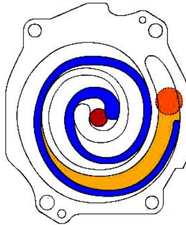
Hình 12.7: Nguyên lý hoạt động của máy nén loại xoắn ốc.
