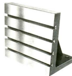
Hình 1.16: Các loại ke gá a) Ke gá có khoan các lỗ, b) Ke gá có rãnh chữ T
