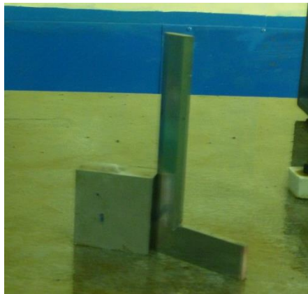
Hình 1-6: Dùng ke vuông để đo các góc cạnh của chi tiết
