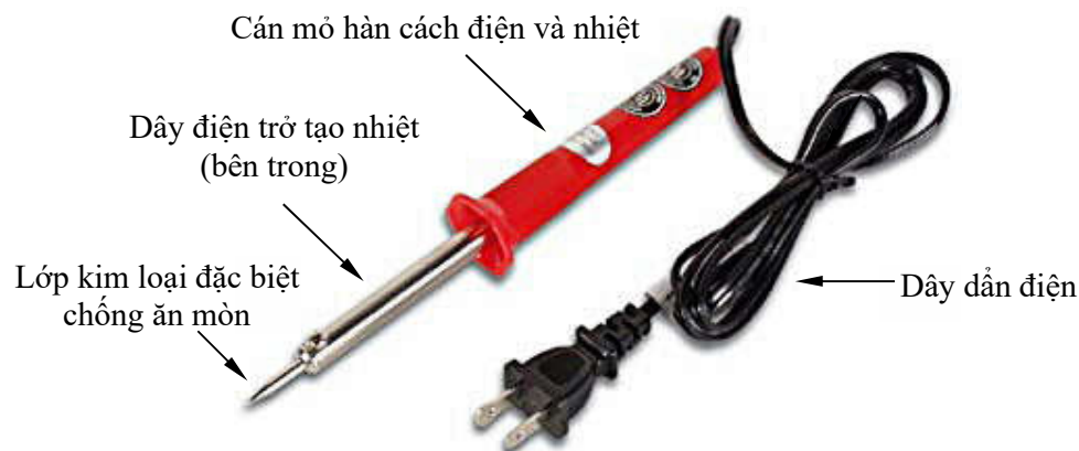
Hình 1: Cấu tạo mỏ hàn
