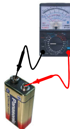
Hình 11: Đo điện áp nguồn điện một chiều
