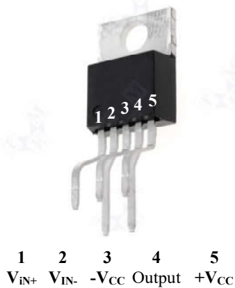
Hình 13a: Hình dạng và sơ đồ chân TDA2040
