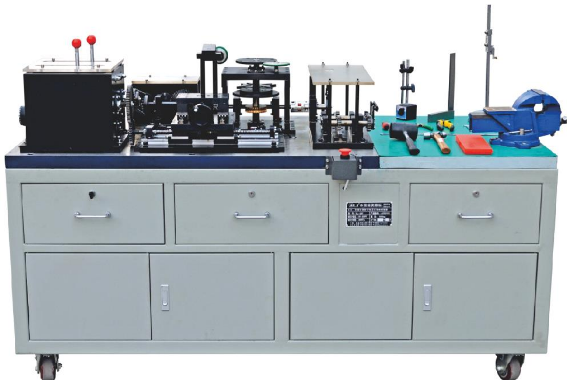
Hình 44: Mô hình lắp ráp và vận hành các cơ cấu truyền động cơ khí
