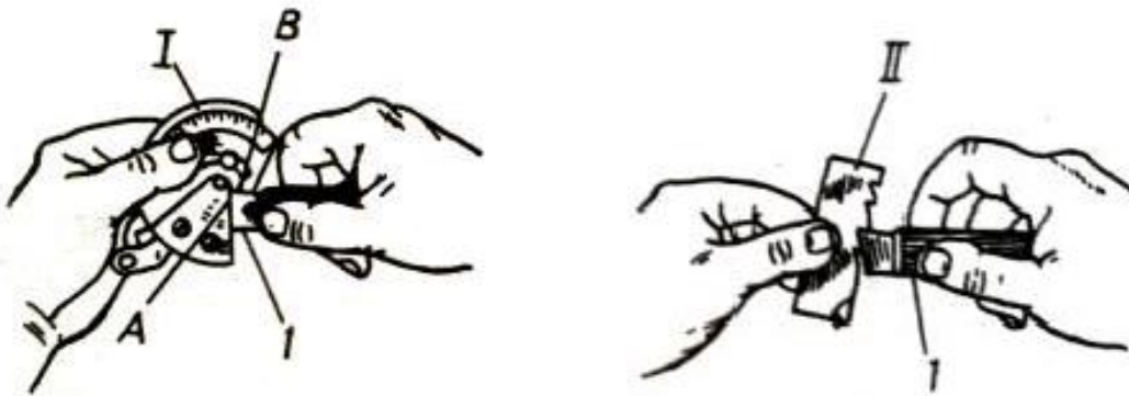
Hình 3.7: Kiểm tra góc dao sau khi mài.
