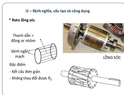
Hình 7.3: Cấu tạo phần Roto
