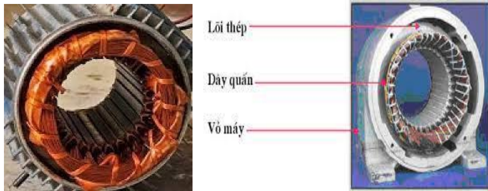
Hình 7.2: Cấu tạo phần Stator
