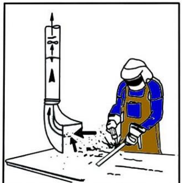
HÚT KHÓI HÀN VÀO HỆ THỐNG HÚT
