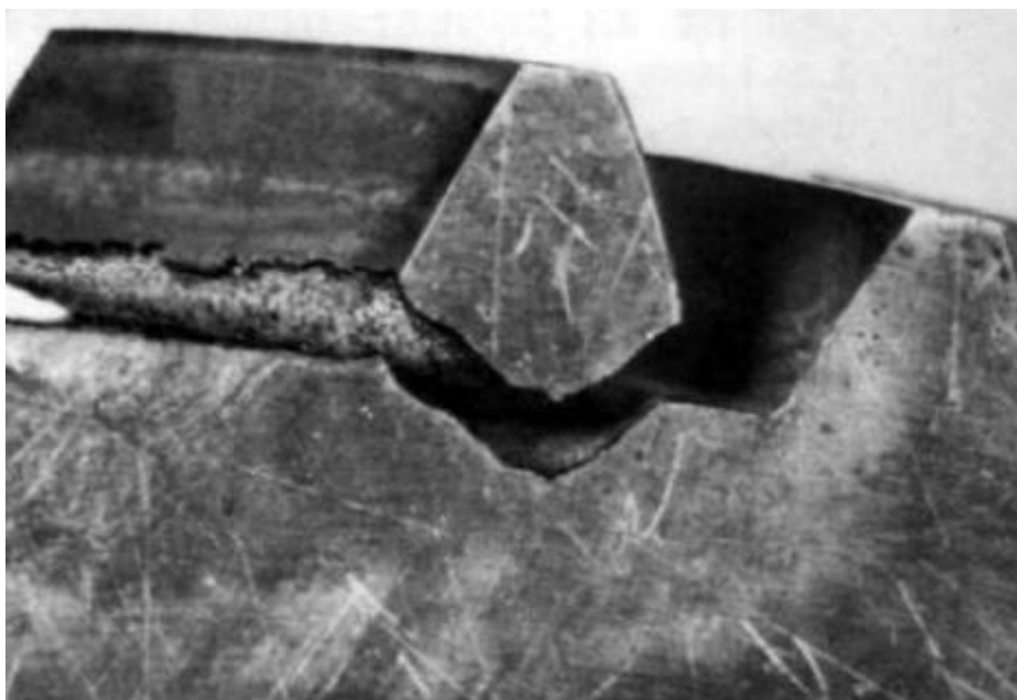
Hình 30: Bộ truyền bánh răng côn bị gãy răng
