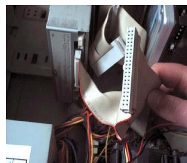
Lắp cáp tín hiệu xuống mainboard
