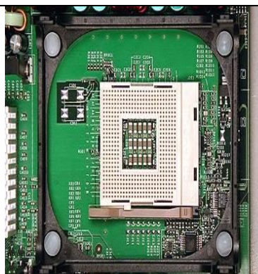
Socket 478 Có : 478 pin; Dùng cho : Celeron, Pentium IV
