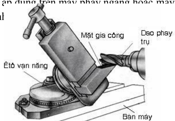
Hình 6.3 Xoay phôi bằng ê tô vạn năng
