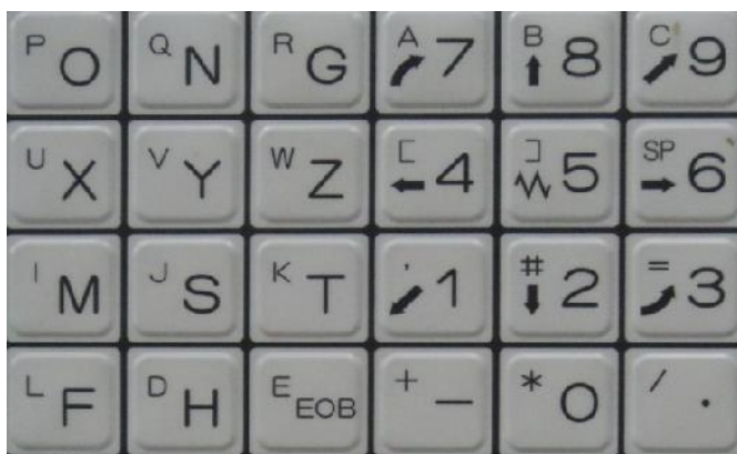
Bảng 3: Phím chức năng máy phay CNC
