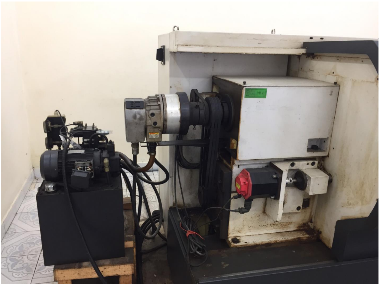
Hình 10: Tiếng ồn từ hệ thống thủy lực và hệ thống truyền động cơ khí (đai, xích, ...)
