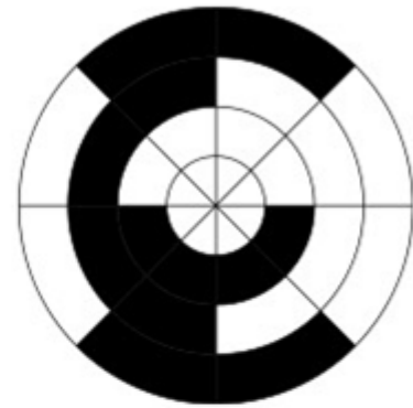
Hình 4.10: Đĩa mã hóa tuyệt đối trường hợp 3 rãnh với mã Gray
