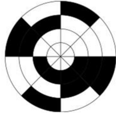
Hình 4.9: Đĩa mã hóa tuyệt đối trường hợp 3 rãnh với mã nhị phân
