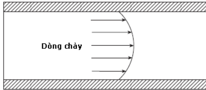
Hình 3.4: Vận tốc dòng chảy với ảnh hưởng của tính nhớt và lực ma sát
