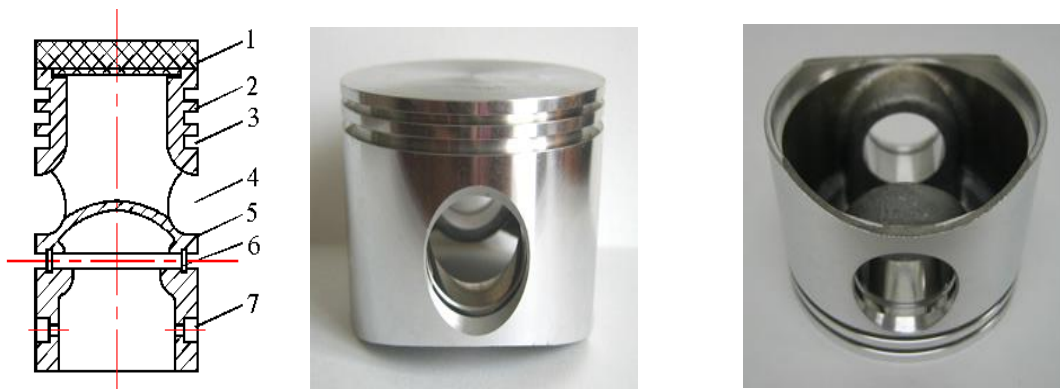
Hình 1.9. Piston máy nén
