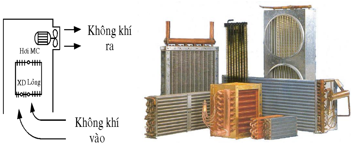
Hình 2.16. Dàn bay hơi làm lạnh không khí cưỡng bức
