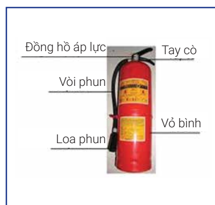
Hình 12. Cấu tạo bình chữa cháy
